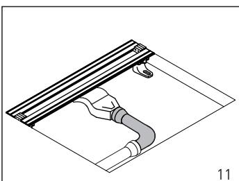
Подсоедините сифон желоба к канализационной трубе, установите монтажную заглушку в канал желоба
