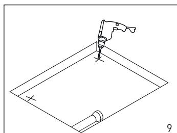
Просверлите отверстия в местах крепления ножек к полу
