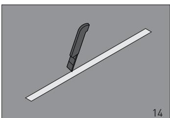
Нанести несколько слоев жидкой гидроизоляции и вырезать ножом в рулонной гидроизоляции отверстие по периметру канала желоба
