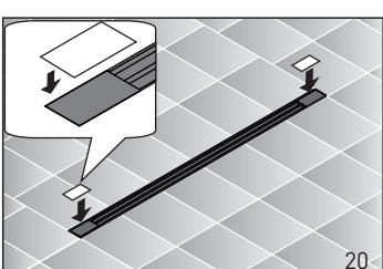
Установить декоративные заглушки в соответствующие пластиковые фиксаторы. Периодически рекомендуется с помощью монтажного ключа снимать решетку с желоба, вынимать сетку для волос из канала желоба и промывать под водой от скопившегося мусора.
