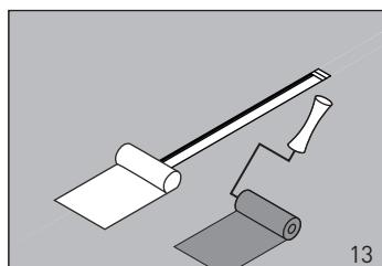
Поверх канала желоба раскатать рулонную гидроизоляцию
