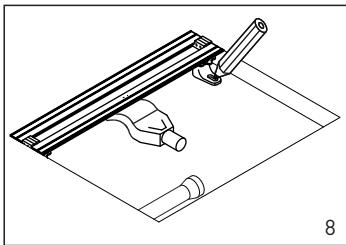
Отметьте места крепления ножек к бетонному основанию
