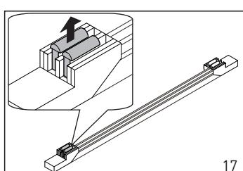
Извлечь из канала желоба монтажную заглушку. Установить в канал фиксаторы решетки и выровнять уровень решетки монтажным комплектом с уровнем плитки.
