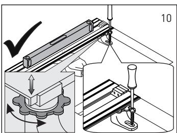
Просверлите отверстия в местах крепления ножек к каналу
