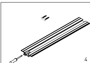
Поставьте заглушки в канал желоба и зафиксируйте саморезами
