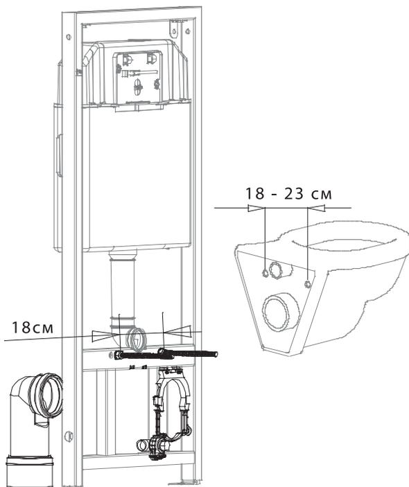
2. Учитывая толщину напольной плитки, определите высоту, на которую вы закрепите унитаз. После этого установите высоту несущих регулируемых ножек рамы. Определите расстояние между стеной и бачком. Затем отрегулируйте и зафиксируйте стенные соединительные части, как показано выше.
