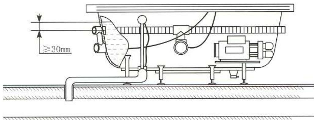
Уровень воды должен быть выше гидромассажных форсунок.
