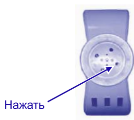
Рис.3. Расположение штока на термовыключателе термостата
