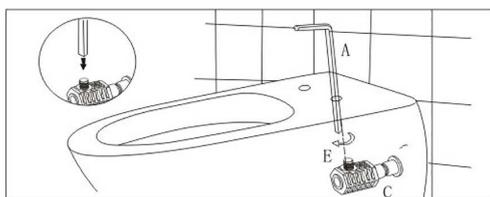
6. Зафиксируйте изделие с помощью ключа A
