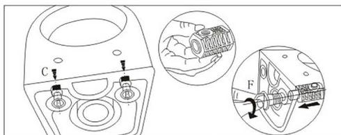
4. Установите крепление C на изделие отверстием вверх с помощью ключа F.
