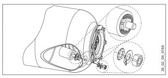
▶ Чтобы обеспечить заземление стального бака при установке защитного анода, необходимо соблюдать последовательность затяжки крепежных элементов.
