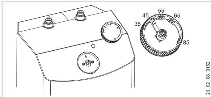
С помощью рычажка, расположенного под ручкой регулятора температуры, можно ограничивать диапазон вращения ручки, т. е. максимальную температуру.
