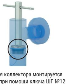
Штуцер для коллектора монтируется через углы при помощи ключа ШГ №12
